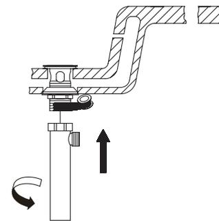
**Etapa 3.** Oriente el conjunto de la pieza contrapunta (7) de forma que la apertura de la palanca de desagüe se sitúe frente a la dirección del conjunto de la varilla de elevación. (Habitualmente el conjunto de la varilla de elevación se sitúa frente a la pared).
